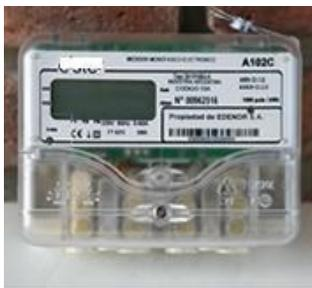
Modelo de medidor de energía eléctrica apto para módulo adquisidor de datos
