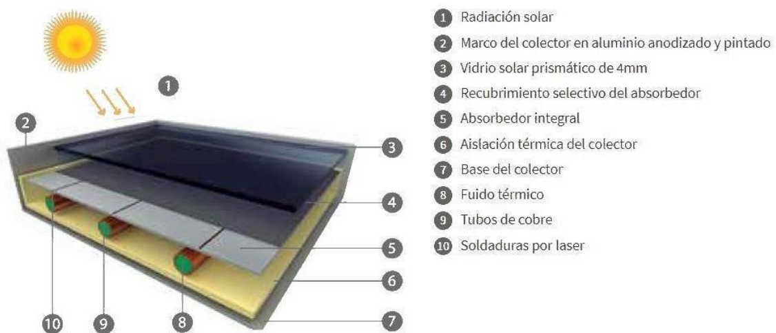
Figura N.º18: Colector solar de Equipo Solar Térmico para ACS. Fuente: Manual de instalación según proveedor de equipo solar térmico.
